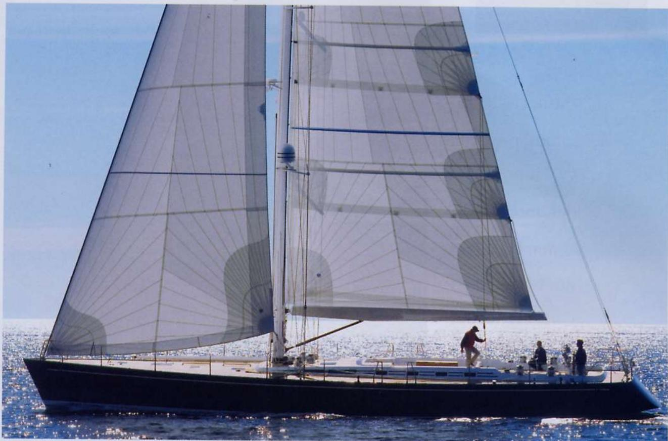
Potente il piano velico dello Swan 75 armato in testa d'albero con una randa di ben 146,5 mq. La coperta di questo modello "flush deck" garantisce spazi enormi in coperta.
